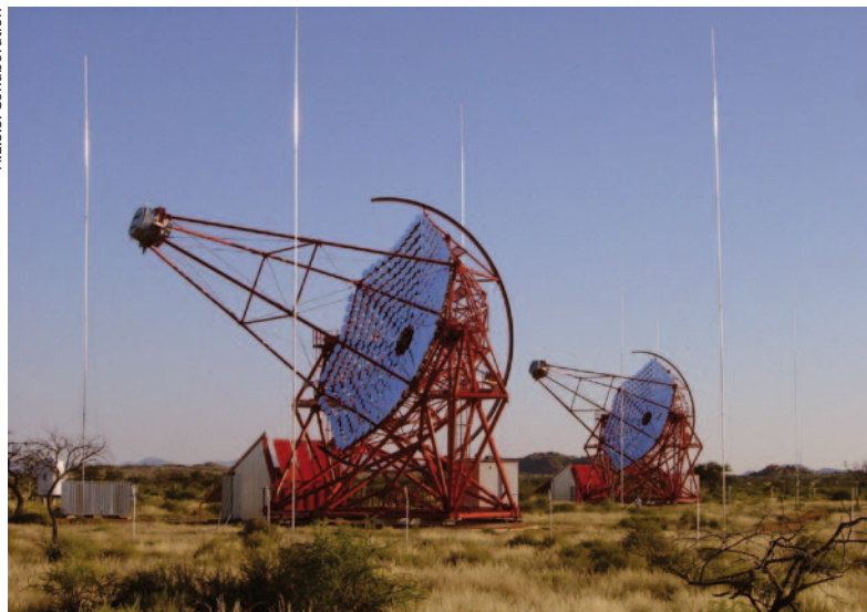
Abb. 4 Der H.E.S.S.-Array in Namibia, von dem hier zwei Teleskope zu sehen sind, misst die Cherenkov-Strahlung und untersucht damit die kosmische Gamma-
