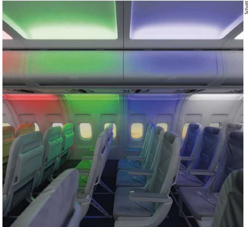
Abb. 1 True-Color-Stabilisierung sorgt für konstante Lichtverhältnisse in der Flugzeugkabine.
