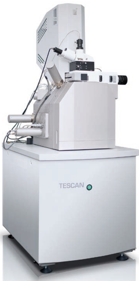
Abb. 1 Das neue, korrelative Raman Imaging und Scanning Electron Microscope (RISE) für Raman- und Rasterelektronenmikroskopie-Messungen wurde von TESCAN und WITec gemeinsam entwickelt.
