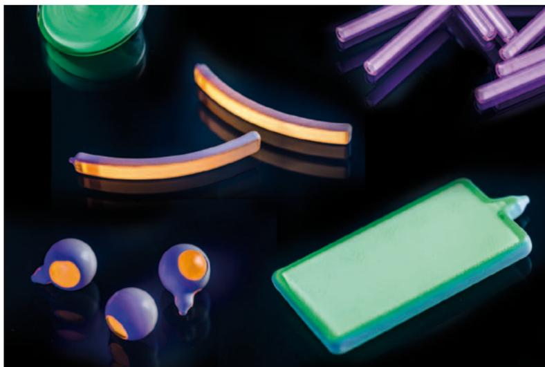
Diese Lichtquellen enthalten gasförmiges Tritium, einen Betastrahler. Die emittierten Elektronen regen einen Leuchtstoff auf der Innenwand des Glaskörpers zur Lumineszenz an. Die Glaskör-
