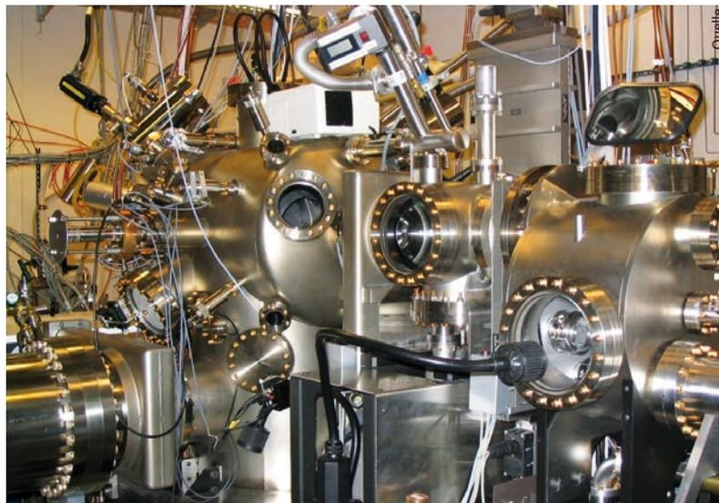
Diese Molekularstrahl-Epitaxieanlage (MBE) wurde Mitte der 1990er-Jahre am Walter Schottky Institut installiert. Sie ist mit Ga, Al, In, As, Si und C bestückt und dient der Herstellung von Vielschicht-
