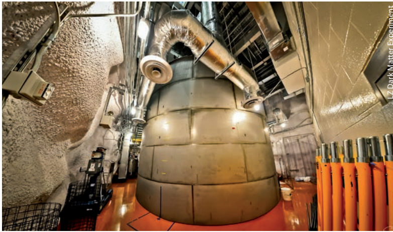
Eine Abschirmung mit hochreinem Wasser umgibt den LUX-ZEPLIN-Detektor. In
