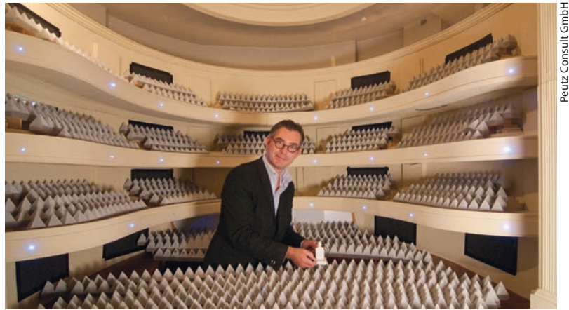
Abb. 2 Um die Auswirkung der zahlreichen kleinen Strukturen des Opernsaals auf den Klang zu untersuchen, entstand ein detailgetreues Modell im Maßstab 1:10.
