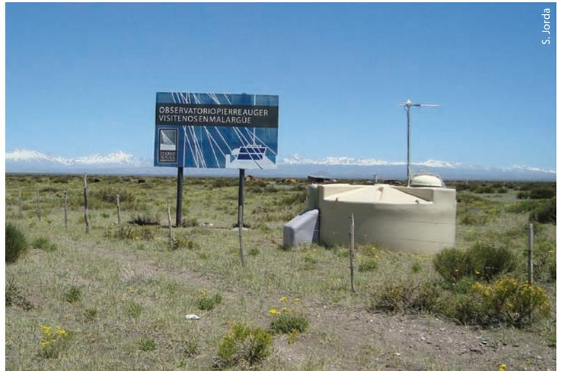
Das Auger-Observatorium besteht aus 1600 solcher Cherenkov-Tanks und umfasst eine Fläche von 3000 Quadratmetern in der argentinischen Pampa Amarilla.
