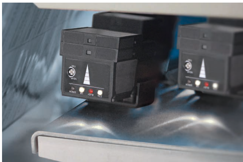
Jede FQ2-Smart-Kamera liest, was der Lasermarkierer geschrieben hat, und sendet diese Informationen als String via Ethernet an die SPS.
