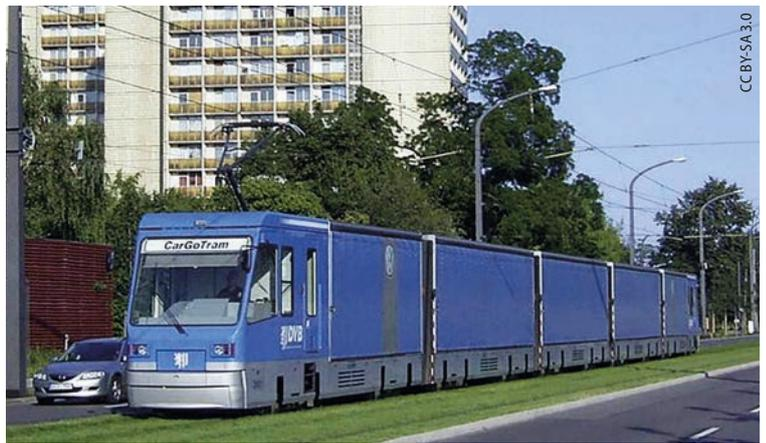
**Abb. 3** Bei der Aufteilung einer Straßentrasse in eine zentrale Bahntrasse mit Autospuren an den Rändern dienen in Dresden während der 2000er-Jahre Güterstraßenbahnen zur Belieferung eines VW-Werkes.
