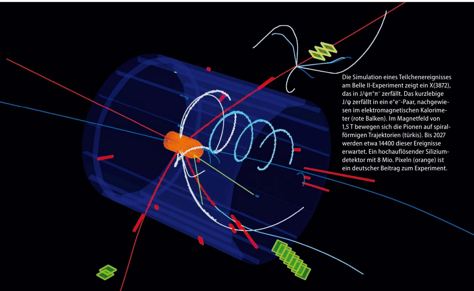
Die Simulation eines Teilchenereignisses am Belle II-Experiment zeigt ein  $X(3872)$ , das in  $J/\psi\pi^+\pi^-$  zerfällt. Das kurzlebige  $J/\psi$  zerfällt in ein  $e^+e^-$ -Paar, nachgewiesen im elektromagnetischen Kalorimeter (rote Balken). Im Magnetfeld von 1,5 T bewegen sich die Pionen auf spiralförmigen Trajektorien (türkis). Bis 2027 werden etwa 14400 dieser Ereignisse erwartet. Ein hochauflösender Siliziumdetektor mit 8 Mio. Pixeln (orange) ist ein deutscher Beitrag zum Experiment.
