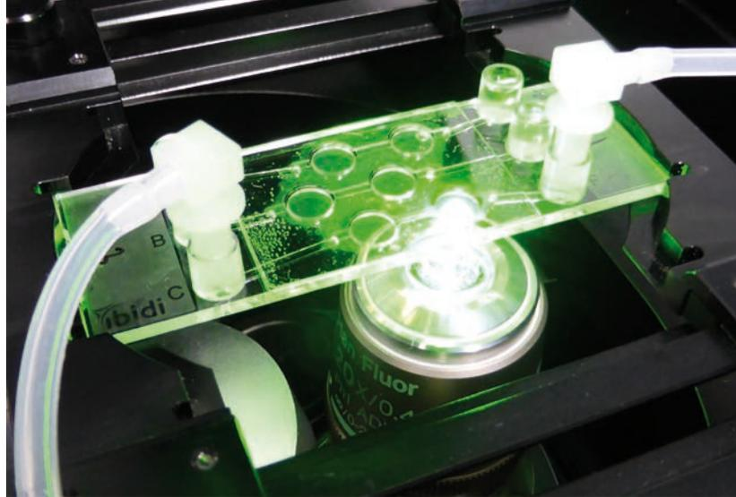
In dem dreikanaligen  $\mu$ -Slide lassen sich Zellen in 3D-Matrizen optimal mit Nährstoffen versorgen und kultivieren.
