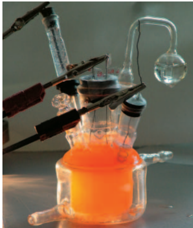
Lebende Brennstoffzelle: E. Coli-Bakterien liefern Strom beim Gären. (Foto: Uwe Schröder)
