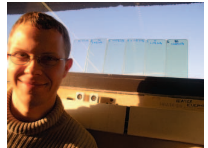
Stephan Schelm vor eine Reihe von Proben des Hitze abweisenden Glases. Mit steigender Konzentration an Nanopartikeln färbt es sich zunehmend grün.
