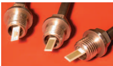
Platinelektroden messen den elektrischen Widerstand von Motoröl.
