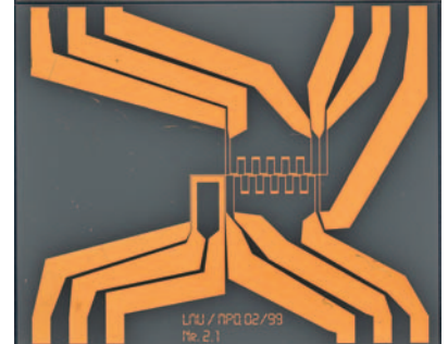
Abb. 3: Experimentell lassen sich Atom-Chips in Form integrierter Leiterbahnstrukturen auf der Oberfläche eines Trägersubstrats für verschiedene Magnetfallen herstellen (oben, Foto: J. Reichel, München/Paris). Links sieht man einen Gesamtaufbau mit dem am oberen Ende auf einem Vakuumflansch montierten Atom-Chip. (Foto: J. Schmiedmayer, Heidelberg)
