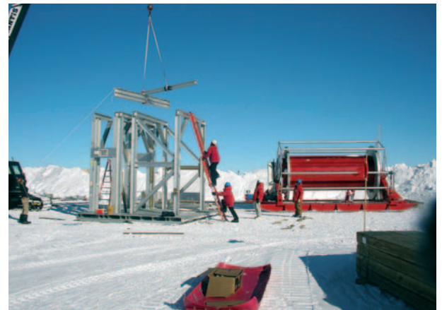
Ingenieure und Techniker bauen den Heißwasserbohrer zusammen, mit dem sie die Löcher für die Detektoren des Neutrino-Teleskops IceCube in das Eis der Antarktis bohren. Nach der Fertigstellung wird IceCube ein Volumen von einem Kubikkilometer haben und hochenergetische Neutrinos aus dem Welt- raum nachweisen. (Foto: Jeff Chervinka)
