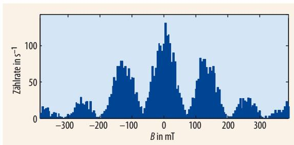
Abb. 4 Die Zählrate des Detektors oszilliert als Funktion des externen Magnetfelds, das senkrecht zur Ebene des Elektronengases angelegt ist.
