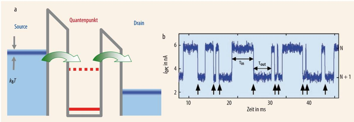
**Abb. 2** Damit ein Elektron durch die Quantenpunktstruktur fließen kann (a), muss es die Tunnelbarrieren überwinden, die durch den Potentialverlauf (graue Linie) zustande kommen. Jedesmal, wenn ein Elektron auf den Quantenpunkt kommt oder ihn verlässt, sinkt bzw. steigt der Strom  $I_{QPC}$  im Ladungs-
