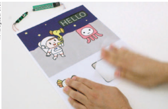
Durch schnelles Reiben der Elektrode erscheint auf einer Bilderbuchseite in einem kleinen E-Paper-Display das Wort „hello“.
