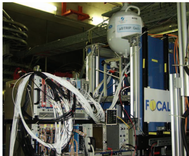
Für die Röntgenspektroskopie hochionisierter Schwerionen wurde eigens ein neuartiges Röntgen-Spektrometer entwickelt, das sog. FOCAL-Spektrometer. 3) (Foto: GSI)
