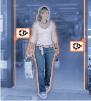
Die kapazitive Leitfähigkeit der menschlichen Haut lässt sich für Einklemmschutz bei automatischen Schiebetüren nutzen.
