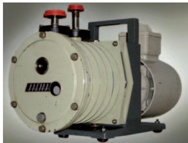
Abb. 1 Eine der ersten Drehschieber-Vakuumpumpen der 60er-Jahre (links). Im Vergleich dazu ein aktuelles Modell (rechts).
